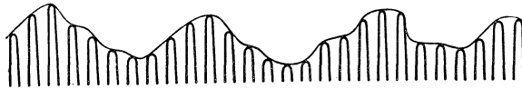
Fig. 4. De gemoduleerde draaggolf wordt in het ontvangtoestel gehalveerd, waarbij, na verwijdering van de laatste resten van de draaggolf, de „geluidstrilling” overblijft.
